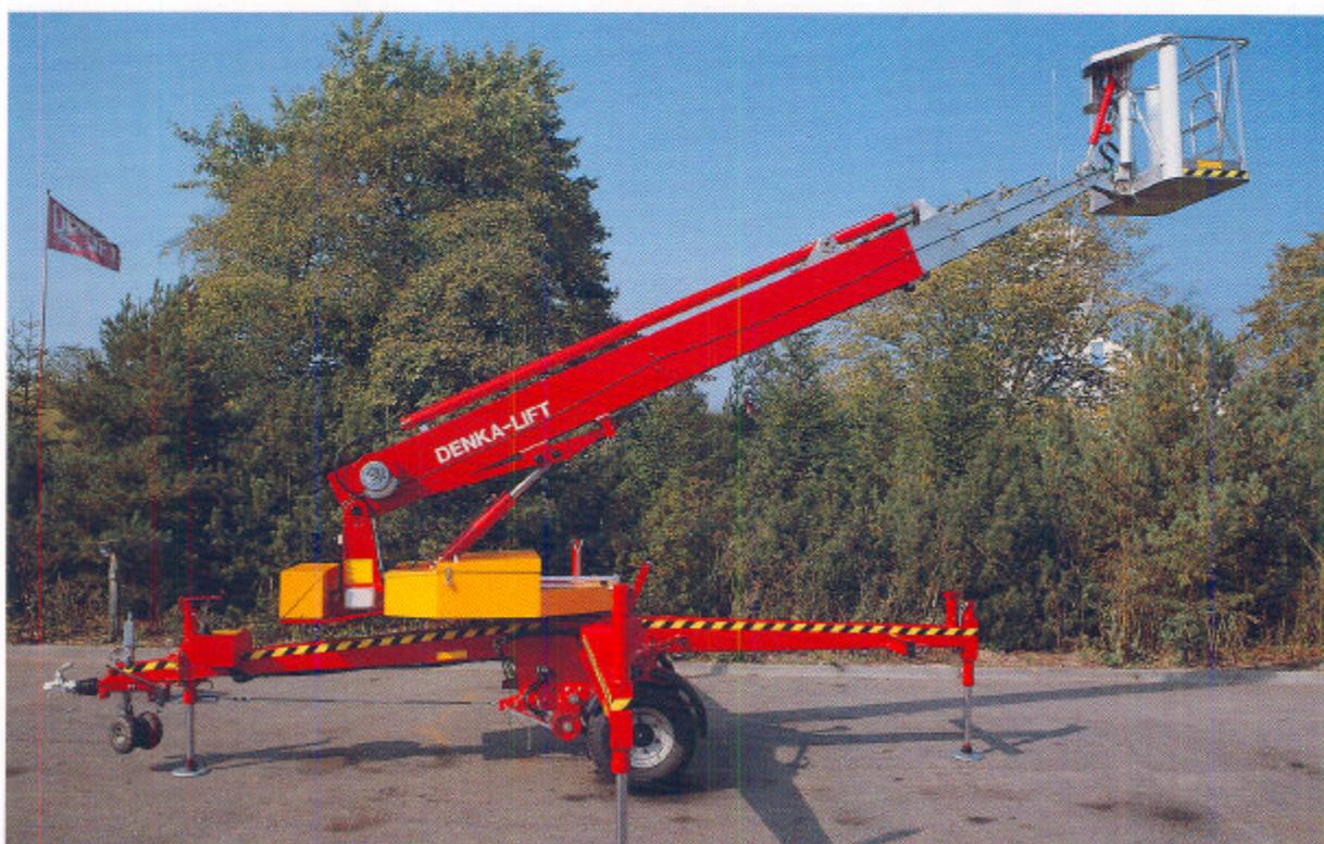
Diese DENKA-LIFT-Serie reicht von 18 m bis 25 m Arbeitshöhe. Der einzigartige Teleskoparm ist aus überdimensionierten, extrudierten Aluminiumprofilen hergestellt. Zusammen mit der sehr feinfühligsten Proportionalsteuerung sind optimale Bewegungsabläufe bei einem überdurchschnittlichen Maß an Stabilität gewährleistet.
